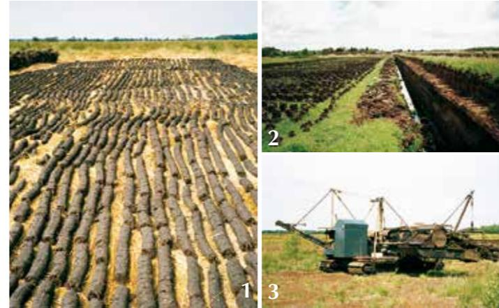
1 = Presstorf kurz vorm „Stukken“ (links oben) · 2 = Törpütt nach dem Baggern · 3 = Torfbagger
